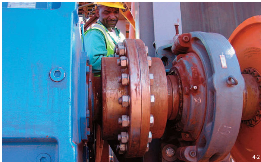
Sprzęgło kołnierzowe RFK 350F- 350M łączące przekładnię zespołu napędow. z bębnem przenośnika taśmowego do transportu rudy żelaza w Płd. Afryce.
