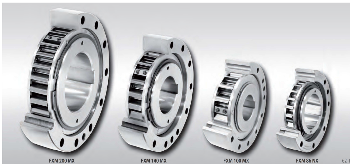
Rodzaj z unoszeniem elementów blokujących typu X wyższa żywotność przez odchylenie elementów blokujących przy szybkoobrotowym pierścieniu wewnętrznym
